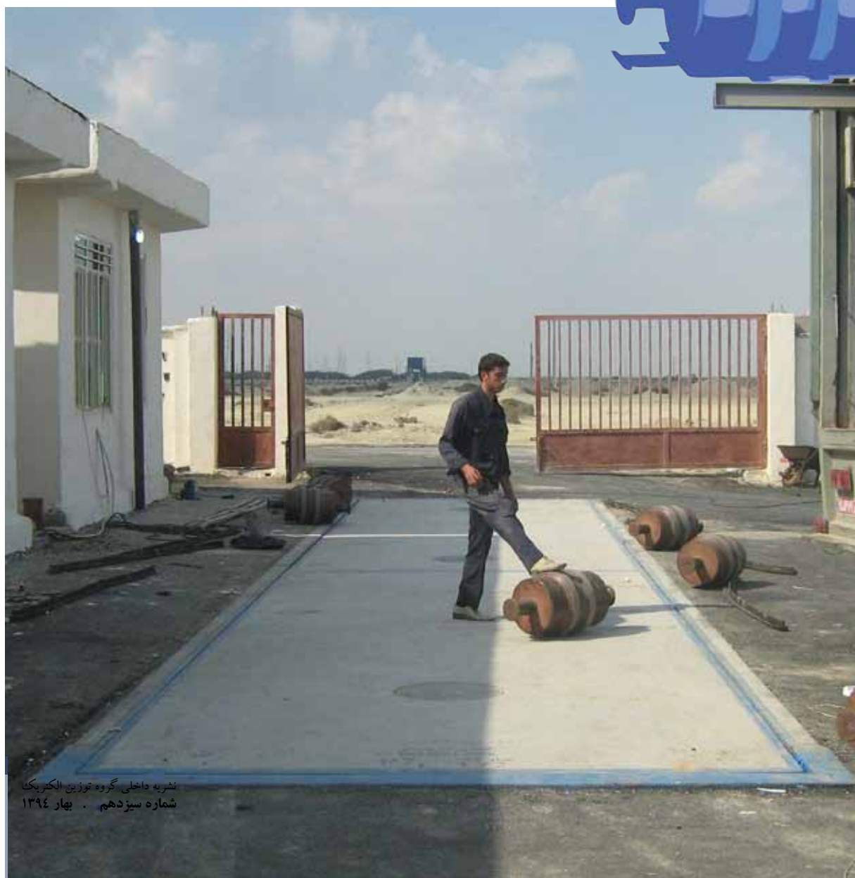
شکل ۱- نحوه انتقال وزنه و تست در استاندارد منسوخ شده ۷۴۷
