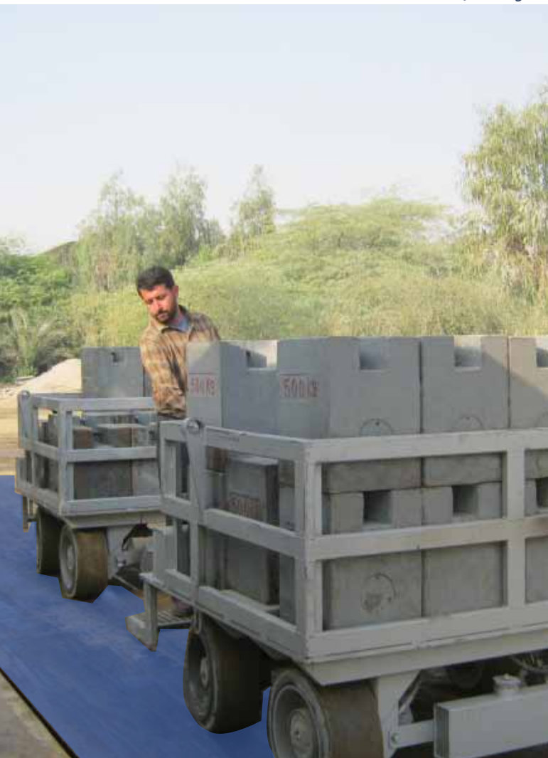
شکل ۲- نحوه انتقال وزنه و تست در استاندارد ۱۰۲۴۷
